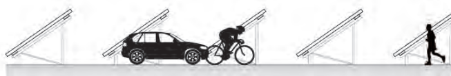
Schaal van zonnepanelen passend bij het Utrechtse landschap, met onder oogniveau minder zichtconfrontatie
